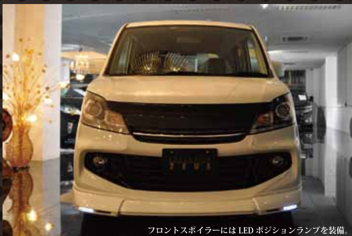
フロントスポイラーには LED ポジションランプを装備。
