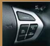
ステアリング右側に設けられたメインスイッチ (ON/OFF) とコマンドスイッチ (CANCEL, SET/COAST, RES/ACC) で簡単に巡航速度を設定できます。アクセルを踏み続けることなく、ロングドライブでも快適なクルージングができます。
